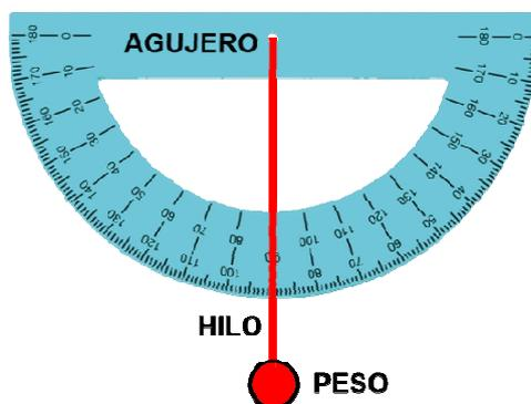
Así, cuando el transportador se mueve el hilo con el peso, debido a la atracción de la fuerza de la gravedad, se mantendrá perpendicular al plano de la tierra. Comprobar que si giramos el transportador el hilo está libre y permite, debido al efecto del peso, que el ángulo de medida cambie.
